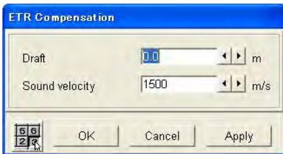
**Draft** : pour obtenir la profondeur à partir de la surface de l'eau (et non à partir du transducteur), saisissez le tirant d'eau du bateau. Plage de réglages : -15 à 60(m).
